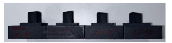
A) 5° Diffuser B) 10° Diffuser C) 5° Nozzle D) 10° Nozzle AOA Study Samples
